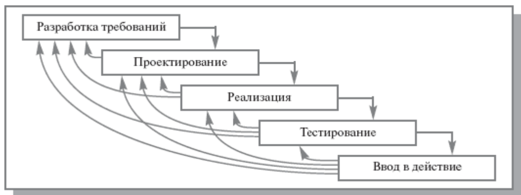
Рисунок 3. Поэтапная модель жизненного цикла информационной системы управления с промежуточным контролем.
