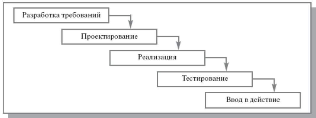
Рисунок 2. Каскадная модель жизненного цикла информационной системы управления.
